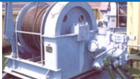
Un moteur STAFFA utilisé pour la motorisation d'un treuil.
