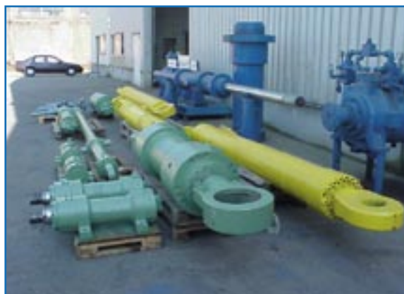
Vérins réparés et peints jusqu'à 10 tonnes.
