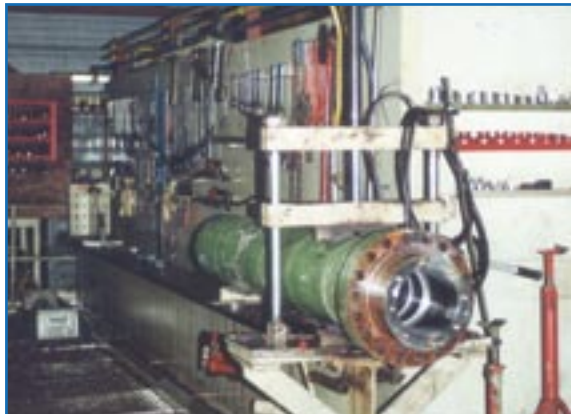
Demontagestand met opvang van olie
